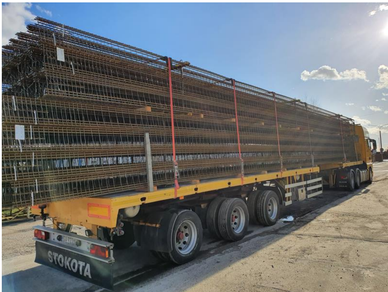
Rysunek 4.1: Centrum Pali Sp. z o. o. - klatki zbrojeniowe
